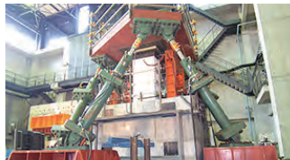
橋脚変形性能実験
